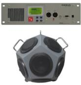
Segons la norma ISO 354 per a la mesura del TR, col·locarem la font en una posició i el sonòmetre en tres posicions. Per cada punt d'ubicació del sonòmetre es faran 2 mesuraments es a dir, un total de 6 mesures.
